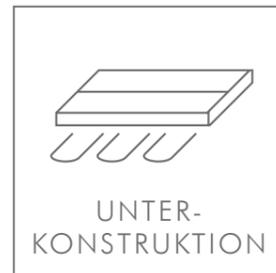
Holz arbeitet - daher muss das Material von Dielen und Unterkonstruktion aufeinander abgestimmt sein. Bei Hartholzdielen ist eine Unterkonstruktion aus Hartholz empfehlenswert, bei Nadelholz sollte eine Konstruktion aus Nadelholz verwendet werden. Alternativ kann auch formstabiles Aluminium gewählt werden, da es als Unterkonstruktion sowohl für alle Holzarten, als auch für WPC Terrassendielen geeignet ist.
